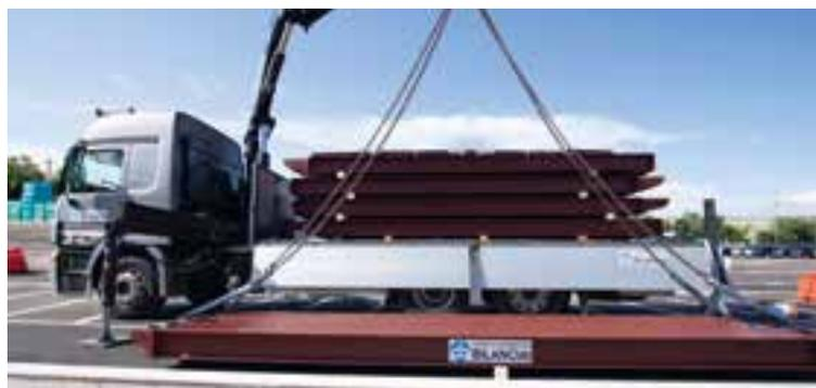
Pesa a ponte in acciaio verniciato con celle digitali o analogiche con corsia centrale longitudinale realizzata con botole di chiusura carrabili dotate di bulloneria Inox, larghezza 50 cm per tutta la lunghezza complessiva della pesa per ispezione e pulizia fondazione.
