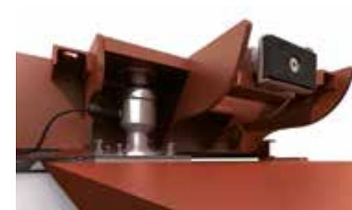
**DOPPIO BORDO DI TESTATA**, insieme ai **LIMITATORI DI OSCILLAZIONE**, realizzati con tamponi in uno speciale materiale antiurto, sono estremamente importanti per ovviare al deterioramento della pavimentazione nelle zone di contatto con il ponte in fase di frenata del mezzo (in presenza di rampe in cemento).
