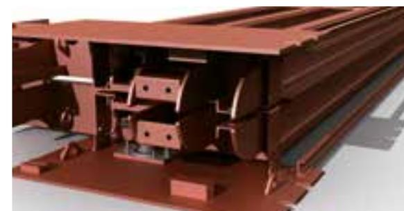
**STRUTTURA METALLICA PORTANTE A TRAVI LONGITUDINALI**, appositamente dimensionata per mantenere inalterate le caratteristiche di resistenza e precisione dell'impianto di pesatura a lungo nel tempo. Il trattamento di sabbiatura e la successiva verniciatura "rosso ossido" ad alto potere anticorrosivo di tutte le parti metalliche del ponte garantiscono una protezione elevatissima all'ossidazione.
