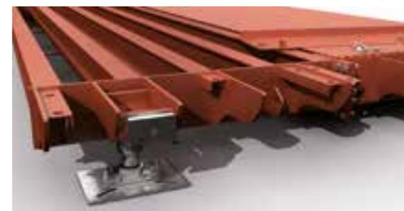
**STRUTTURA METALLICA PORTANTE** a travi longitudinali, appositamente dimensionata per mantenere inalterate le caratteristiche di resistenza e precisione dell'impianto di pesatura anche in condizioni di utilizzo particolarmente gravose. Il trattamento di sabbiatura e la successiva verniciatura "rosso ossido" ad alto potere anticorrosivo di tutte le parti metalliche del ponte garantiscono una protezione elevatissima all'ossidazione.
