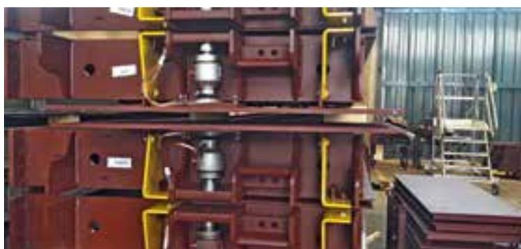
Pesa a ponte modulare in acciaio verniciato di soli 28,5 cm di altezza, per installazioni sopraelevate. Equipaggiata con celle di carico DIGITALI di produzione Cooperativa Bilanciai, mod. CPD-M
